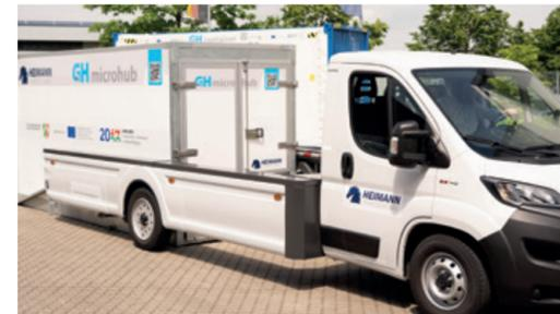
Abstellen des Microhubs durch hydraulisches Absenken. Kein Werkzeug erforderlich. Innerhalb weniger Sekunden kann die Ladefläche auf Knopfdruck abgestellt werden. Be- und Entladen des Koffers ist von Stirn- und Rückseite möglich.
