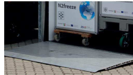
Durch die ebenerdig Absenkung wird eine Ladehöhe von 80 mm erreicht. Die Beladung der Ladefläche ist mit Rollwagen, Deichselstaplern, Paketwagen oder Sackkarren möglich. Der Rampenwinkel ist kleiner als 5°
